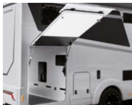
Volume de charge particulièrement grand grâce à la hauteur du double plancher de 30 cm.
