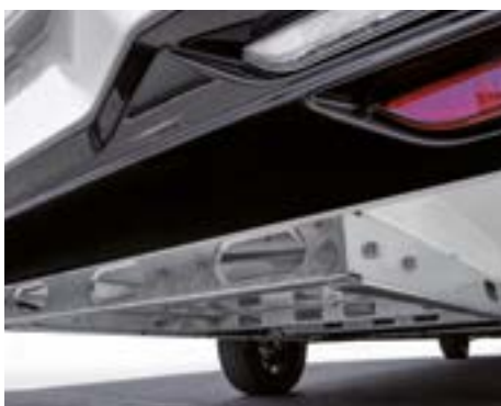
Châssis spécial surbaissé pour une conduite sûre et un volume de charge maximal.
