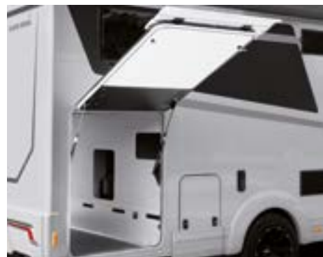
Volume di carico particolarmente ampio grazie all'altezza del doppio pavimento di 30 cm.
