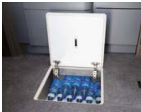
Le botole a pavimento consentono l'accesso anche dall'interno allo spazio di stivaggio nel doppio pavimento.
