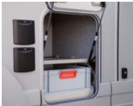
Sportelli con apertura verso l'alto per agevolare le operazioni di carico e scarico.
