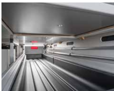
Bac de rangement accessible des deux côtés et de l'intérieur. Pour le chargement des caisses Euro intégrées et de la cuve de plancher protégée contre l'humidité.
